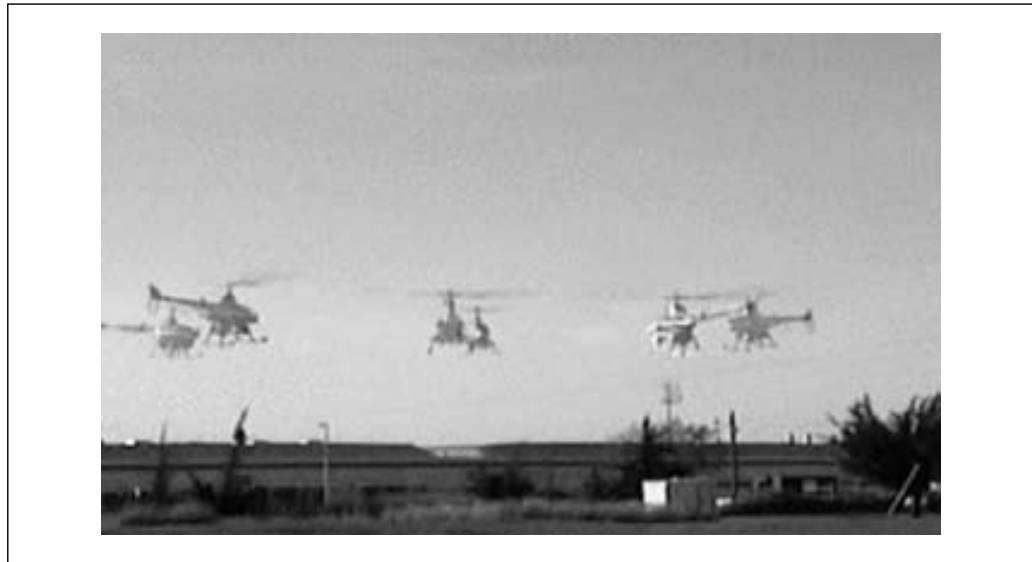
Figura 21.10 Imágenes superpuestas en un período de tiempo de un helicóptero autónomo realizando una peligrosa maniobra circular. El helicóptero está bajo el control de una política desarrollada por el algoritmo de búsqueda de la política PEGASUS. Se desarrolló un modelo simulador observando los efectos de varias manipulaciones de control en helicópteros reales; el algoritmo fue ejecutado en el modelo simulador por la noche. Se desarrollaron una gran variedad de controladores para diferentes maniobras. En todos los casos, el rendimiento obtenido excedió por mucho el de un piloto humano experto utilizando control remoto. (La imagen es cortesía de Andrew Ng.)
